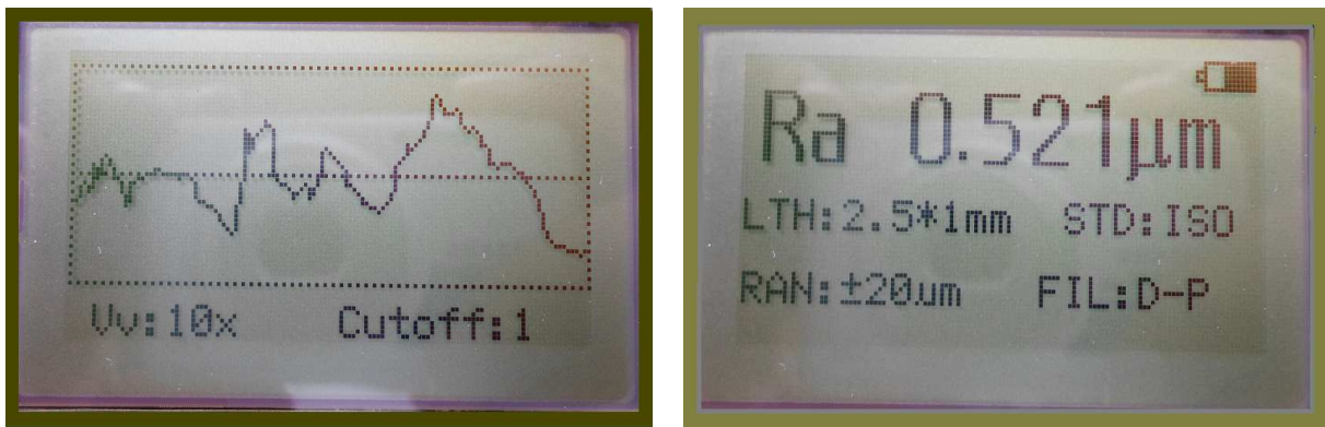
Fig.5 Graphe et la valeur de rugosité obtenu par le rugosimètre d'une pièce rectifiée.
