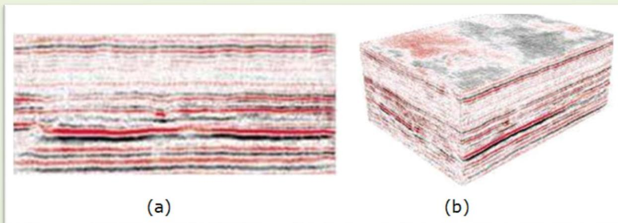
Fig.10 Section sismique 2D(a) et 3D(b)
